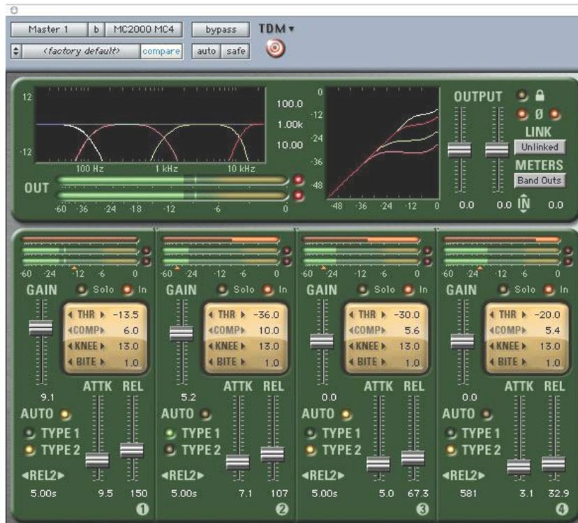
fig. 12: il compressore multibanda
